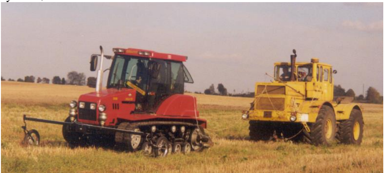
Рис. 9. Испытания трактора БЕЛАРУС-2103 с резиноармированной гусеницей.
