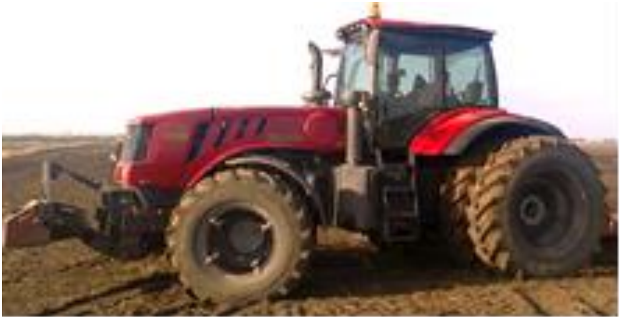
Рис. 6. Трактор БЕЛАРУС-3023 с электромеханической трансмиссией
